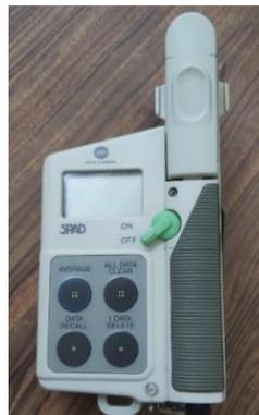
**Figura 3.10** Medidor de clorofila SPAD 502.
