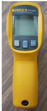
**Figura 3.8** Termómetro infrarrojo Fluke.
