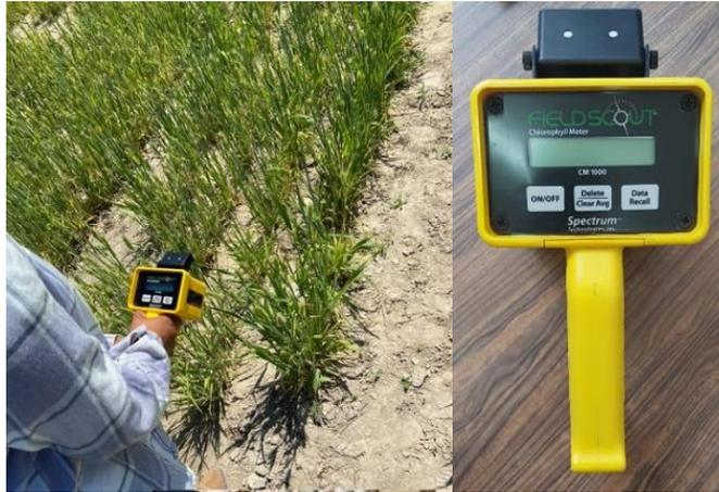
**Figura 3.9** Medidor de clorofila Spectrum CM.1000.
