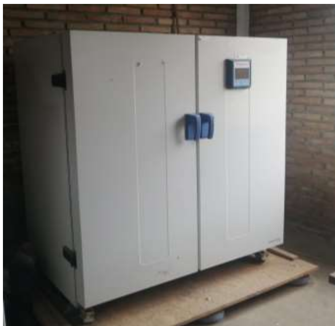
Anexo 10. Estufa Thermo Scientific a 105°C para el secado de plantas de Yucca endlichiana .
