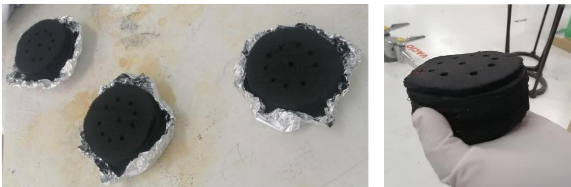
**Figura 3.** Diseño del paquete de electrodos usados para el reactor unitario.
