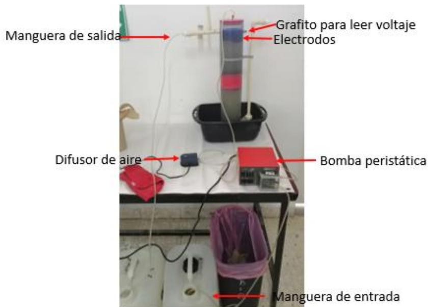
**Figura 5.** Sistema bioelectroquímico sin membrana utilizado durante la experimentación.
