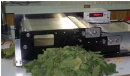
**Figura 3.1.** Medidor de área foliar (LI-COR, modelo LI -3100).
