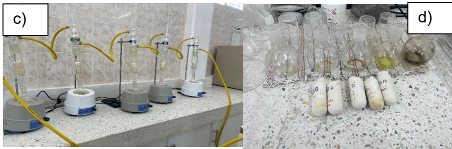
Figura 10. c) Método de Soxhlet y d) Matracas con grasa extraída del alimento comercial.
