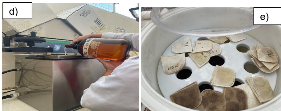
Figura 11. d) Método Ankom y e) Bolsas digestoras con muestra.
