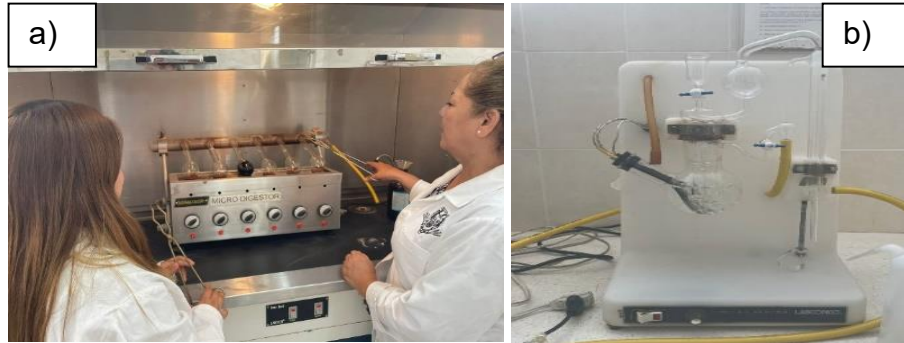
Figura 9. a) Micro Digestor y b) Destilador de proteína.
