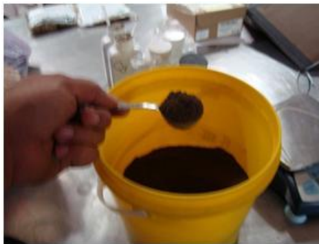
Figura 3. Suelo perfectamente mezclado listo para montaje de pruebas.
