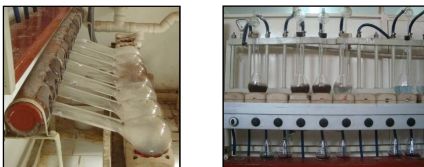
Figura 17. Obtención de nitrógeno del aparato Macrokjeldhal (digestión, destilación y titulación).
