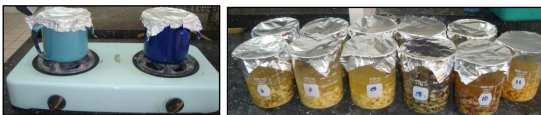
Figura 11. Cocimiento del maíz en recipientes de peltre en una estufa normal de gas. Reposo en vasos de precipitado de 500ml tapados con papel aluminio.
