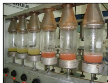
Figura 10. Fibra cruda por medio de una digestión ácida con ácido sulfúrico 0.225 N y una digestión básica con hidróxido de sodio 0.313 N.
