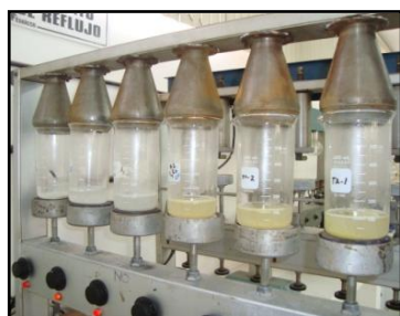
Figura 10. Fibra cruda por medio de una digestión ácida con ácido sulfúrico 0.225 N y una digestión básica con hidróxido de sodio 0.313 N.
