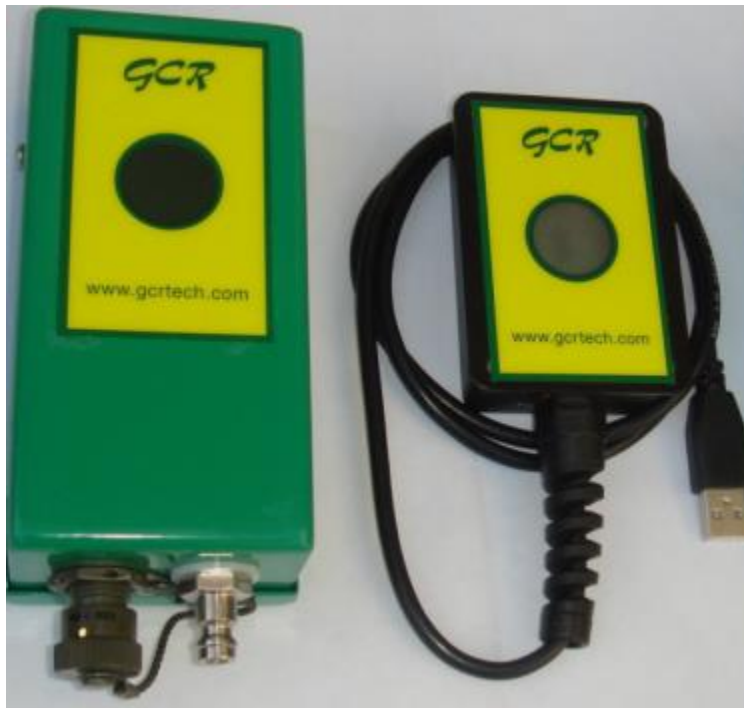
Imagen 34 Ficha técnica TRITON I PF registrador de datos
