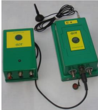
Imagen 31 Ficha técnica GPRS NEPTUNE II FM-controlador de presión
