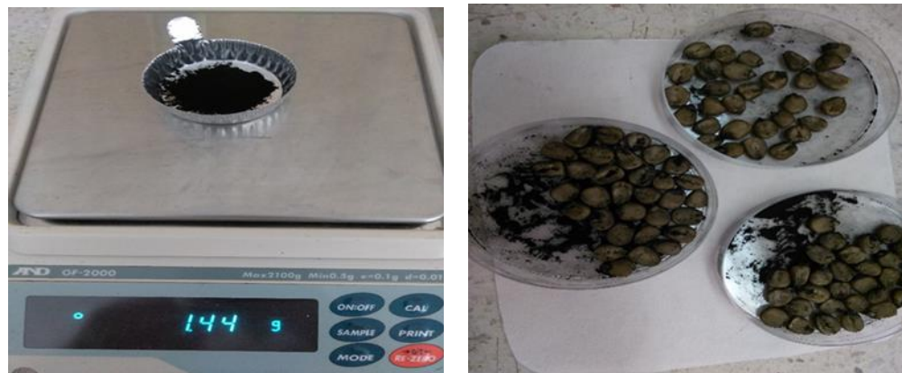
Figura 2. Aplicación de carbón activado a las semillas del tratamiento T2, aplicación en seco. Cantidad de carbón activado utilizado (Izq.) y semillas con el recubrimiento en seco (Der.)
