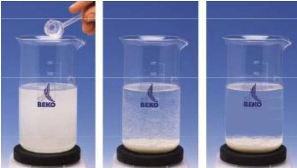
Figura 2. Proceso de floculación del agua (tomado de Pérez, 2011a).
