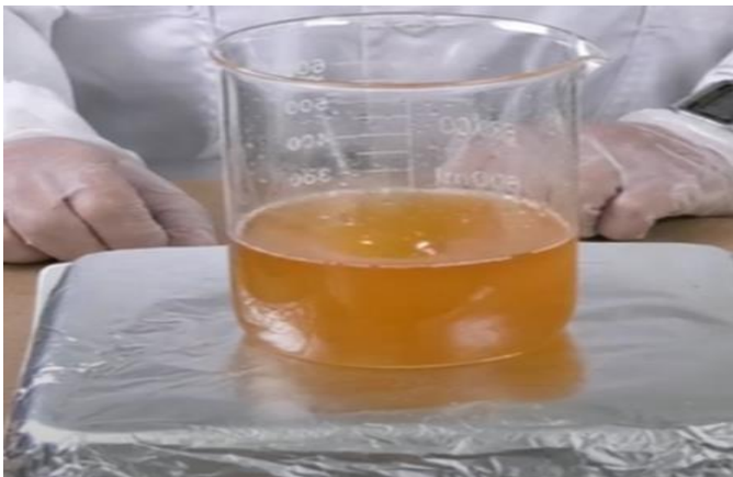
FIGURA 15 mezcla del aceite de semilla de higuera y \text{CH}_3\text{OH} + \text{KOH} = \text{CH}_3\text{KO} + \text{H}_2\text{O}
