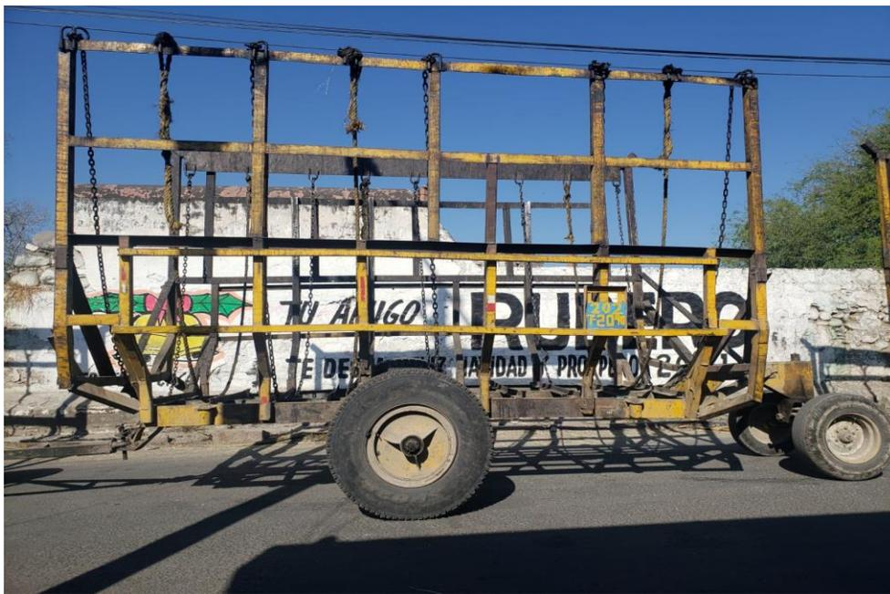
**Figura 3.8** Fotografía del implemento de transporte o remolque utilizado para el transporte de caña azucarera (Elaboración propia).
