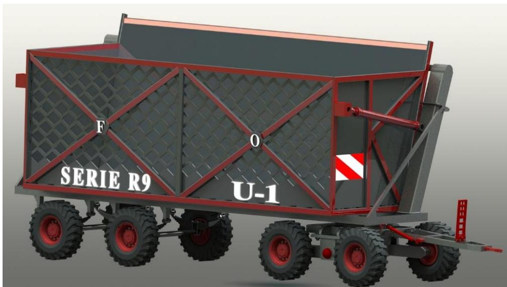
**Figura 4.19** Ensamble de caja con el chasis y estructura para descarga (Elaboración propia).
