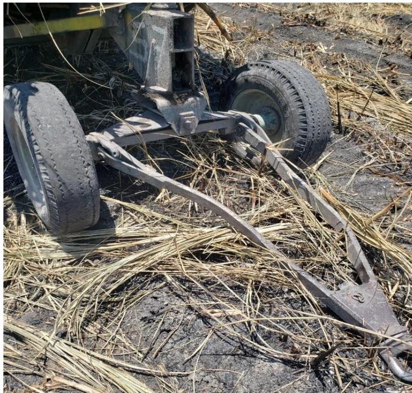
**Figura 3.11** Fotografía tomada de la deformación en la estructura de enganche (Elaboración propia).
