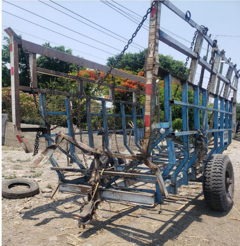
**Figura 3.12** Fotografía tomada del colapso estructural por cargas excesivas y sin señalamientos de precaución (Elaboración propia).
