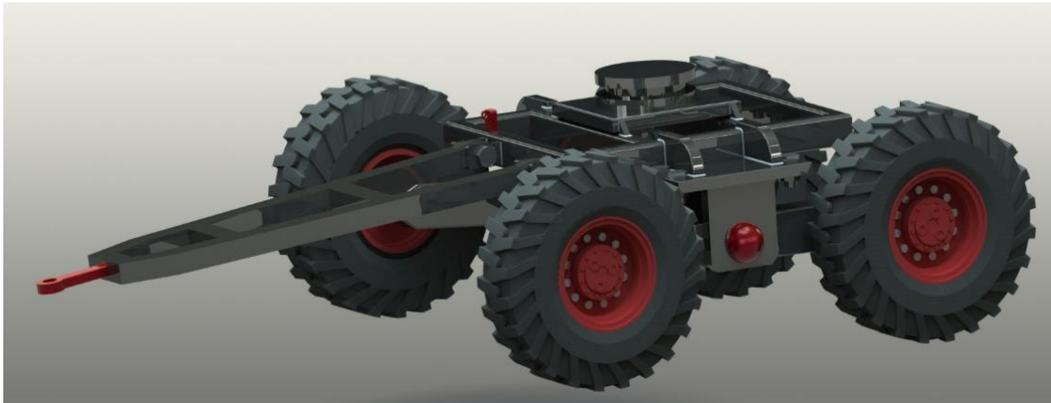
**Figura 4.15** Ensamble del disco de dirección (Elaboración propia).
