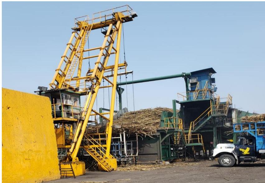
**Figura 3.7** Fotografía de la grúa en función de descarga en la mesa alimentadora (Elaboración propia).
