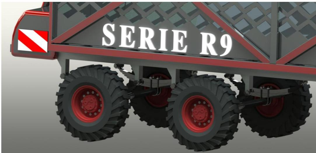
**Figura 4.22** Ensamble de componentes de neumáticos traseros (Elaboración propia).
