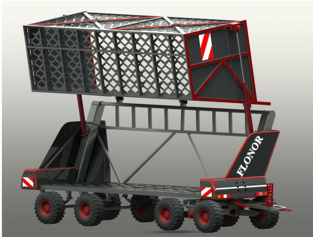
**Figura 4.25** Acción de descarga del implemento de transporte (Elaboración propia).
