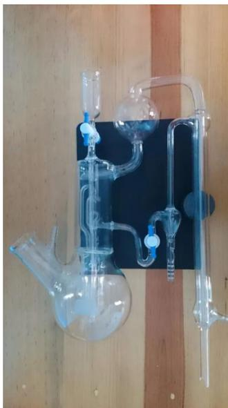
Figura 3. Fotografía de un micro kjendahl LAB-CONCO 65000
