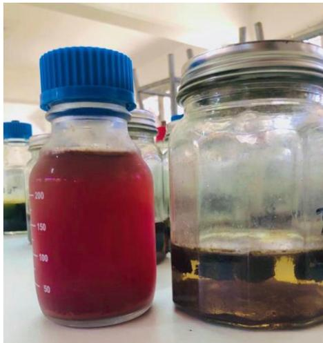
**Figura 3.7** Agua residual sin tratamiento y agua residual tratada con soporte figura grafito 0.5%.
