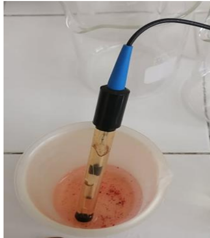
Figura 37. Toma de lectura del pH con potenciómetro.
