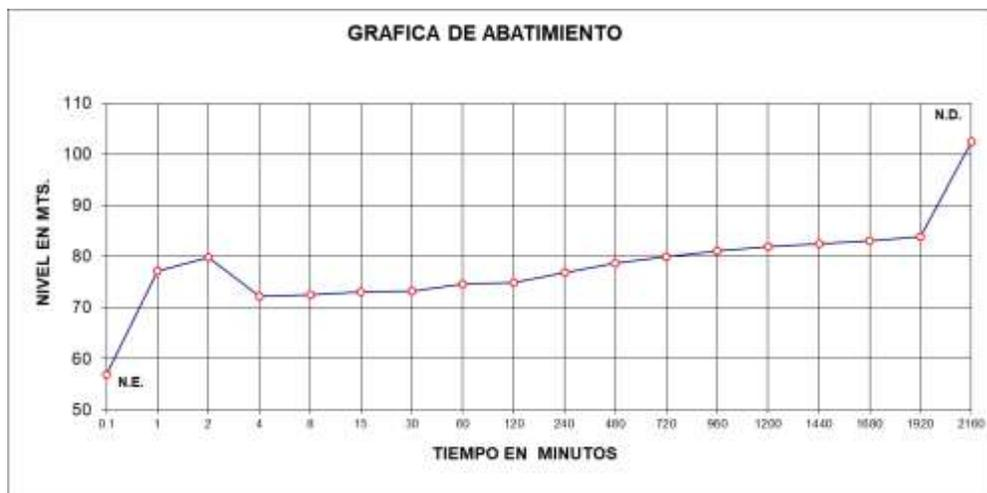
**Figura 10.** Abatimiento de un pozo en una prueba de bombeo
