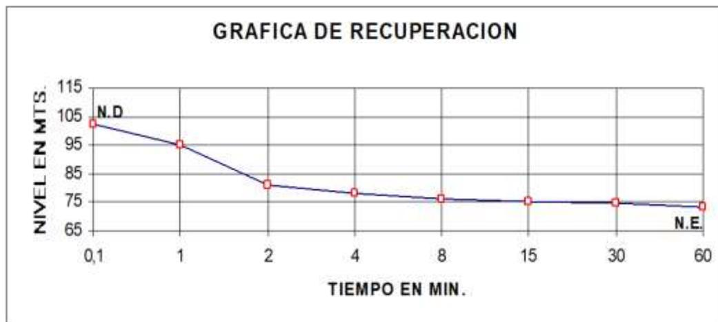
**Figura 12.** Recuperación de un pozo después de una prueba de bombeo
