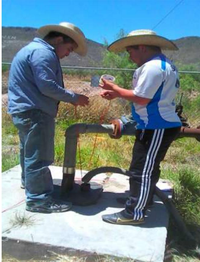
**Figura 28.** *Medición del nivel estático y dinámico con la sonda diferencial*
