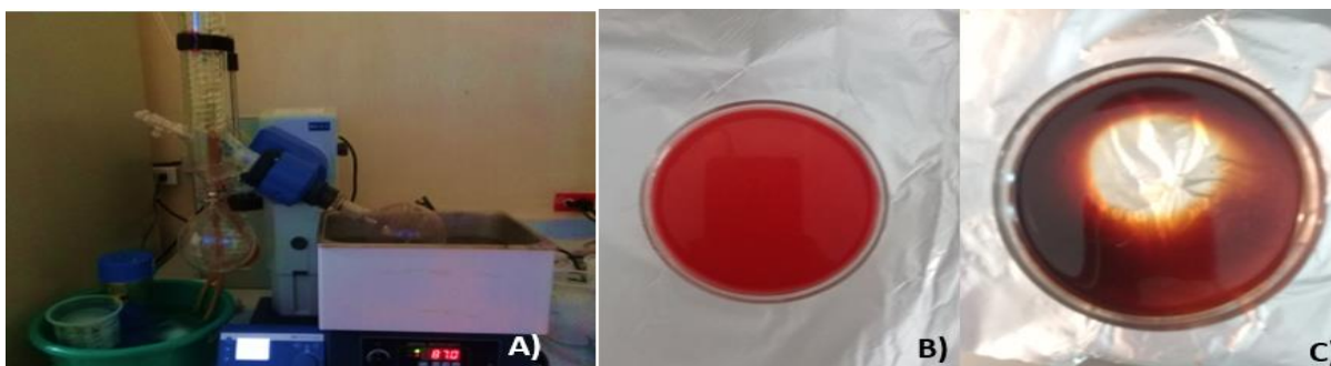
Figura 5. Preparación de extractos de M. geometrizans : A) Concentración en rotavapor de los extractos; B) Extracto acuoso (EA) concentrado; C) Extracto hidroalcohólico (EHA) concentrado.
