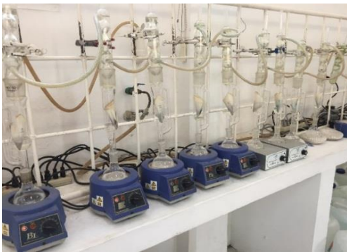
Figura 3.11 Proceso de extracción de grasa
