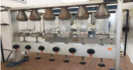
Figura 3.9 Vaso Berzelius en aparato de reflujo
