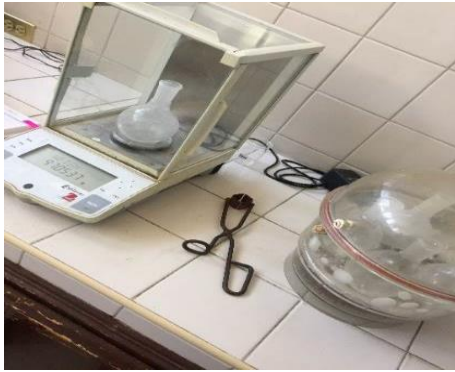
Figura 3.12 Pesaje de matraz en balanza analítica
