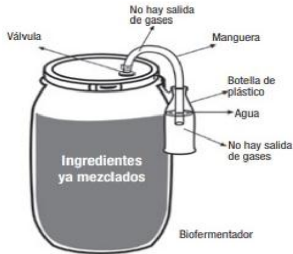
Imagen 3.-Recipiente con biopreparado listo para usar después de 30 a 50 días de fermentación.
