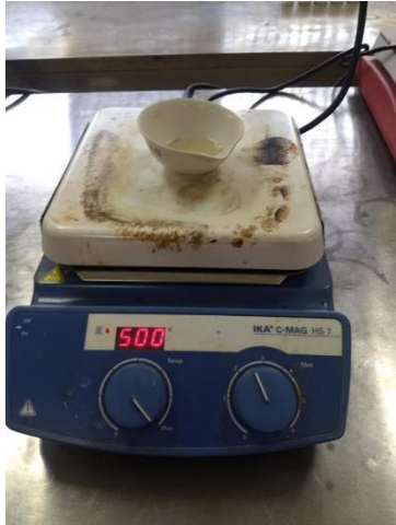
Figura 3.13. Evaporación de muestras.
