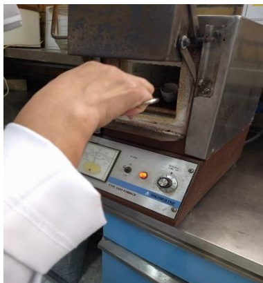
Figura 3.11. Calcinación de los SST.
