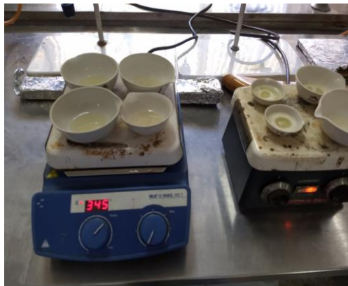
Figura 3.15. Determinación de STV.
