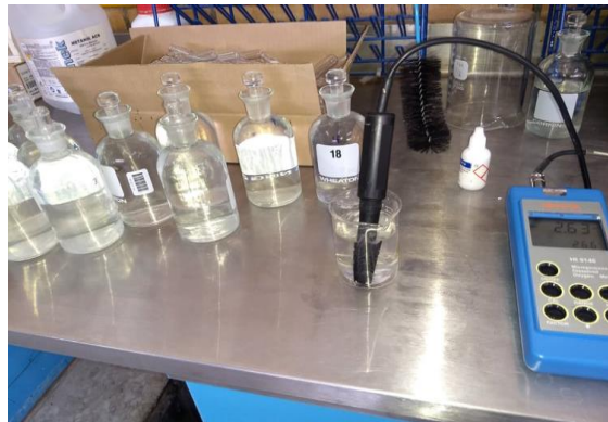
Figura 3.6. Medición de OD inicial y final.
