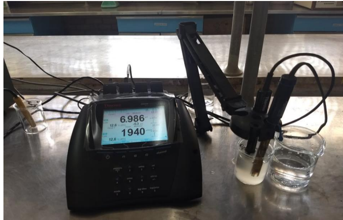
Figura 3.5. Aparato ORION VERSASTAR utilizado para medir CE y pH.
