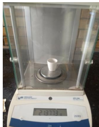
Figura 3.12. Pesado de crisoles.
