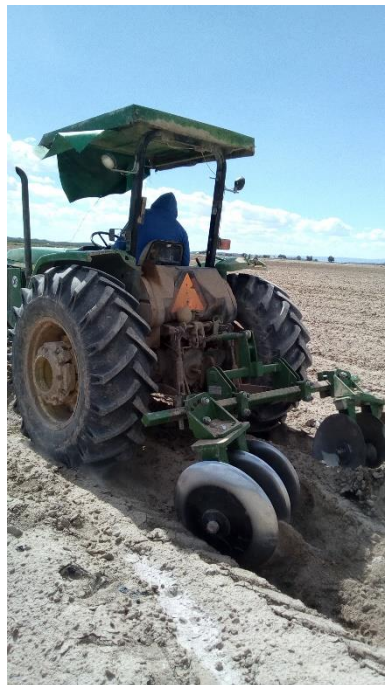
Figura 14. Actividad de bordeado, aplicando el orden de 9-18-18-18-9. Fotografía obtenida en, la unidad de Santa Paulina, Paila, Coahuila.
