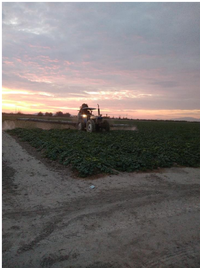
Figura 27. Fumigación en el cultivo de melón con una pulverizadora Jacto Falcón Vortex equipada con turbina y mangas conductoras de aire. Fotografía obtenida en la unidad de producción San José, Paila, Coahuila.
