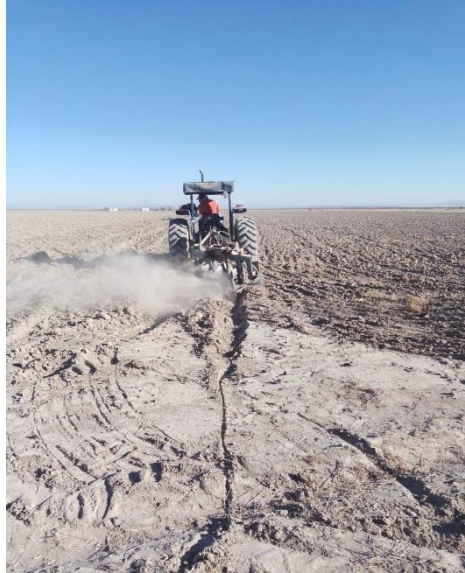
Figura 11. Primera pasada de barbecho, utilizando un arado de 4 discos marca New Holland. Fotografía obtenida en la unidad de producción La Coquena, Paila Coahuila.
