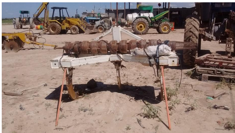
Figura 10. Subsuelo de tres picos, utilizado en los terrenos “calíchantos” y muy compactados. Foto obtenida en la unidad de producción San José, Paila, Coahuila.
