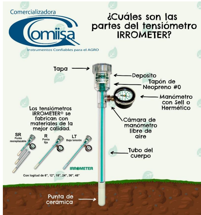
Figura 20. Partes de un tensiómetro. Obtenido de: COMIISA www.Comiisa.com.mx . (30 abril, 2021).
