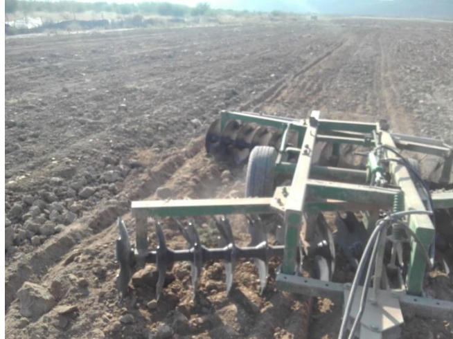
Figura 12. Uso de una rastra de 36 discos marca John Deere, para dar la primera pasada de rastra en terreno previamente barbechado. Fotografía obtenida en la unidad de producción Santa Paulina, Paila Coahuila.
