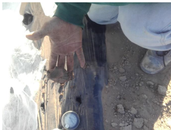
Figura 21. Determinación de humedad por tacto en suelos arenosos. Fotografía obtenida en la unidad de producción San José, Paila, Coahuila.
