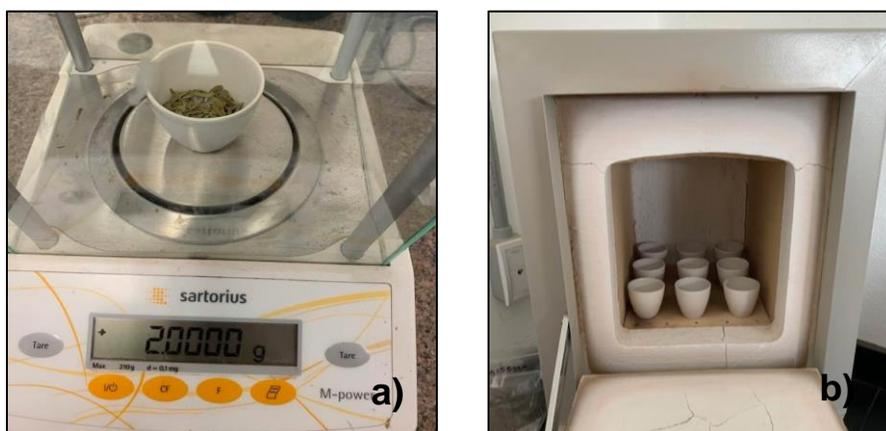
**Figura 11.**a) Toma de muestra. b) Calcinación de muestras en mufla.
