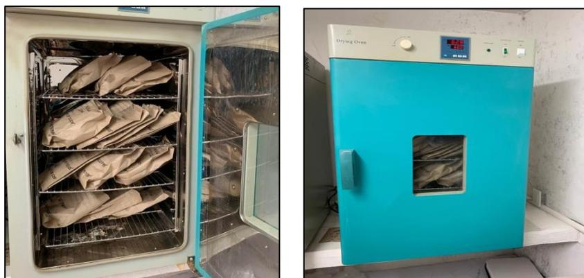
**Figura 9.** Secado de las muestras en estufas.
