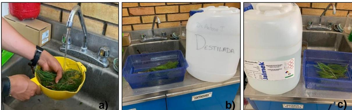
**Figura 8.** Lavado de muestras. a) Agua de llave. b) Agua destilada. c) Agua desionizada,
