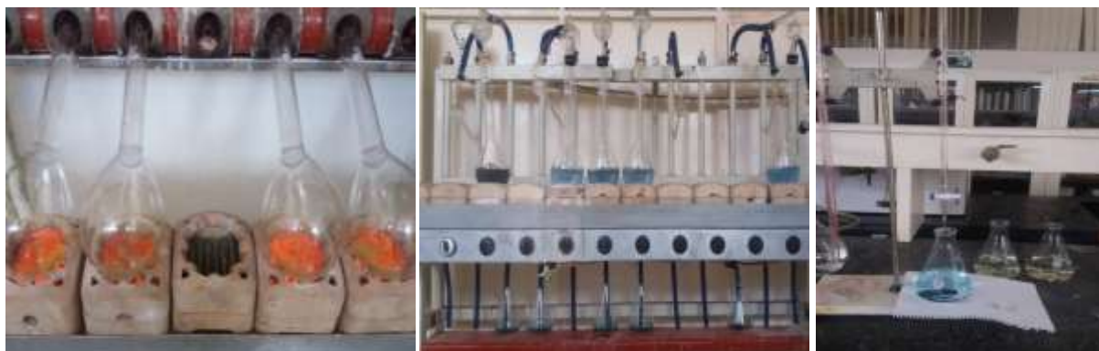
Figura 16. Determinación de nitrógeno orgánico por método Kjeldahl.
