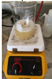
Figura 7. Hidrólisis de fibras sobre parrilla de agitación.
