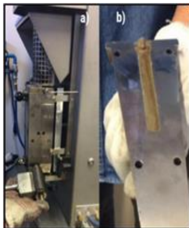
Figura 17. a) Pistón descargando el material. b) Molde con probeta ya inyectada
