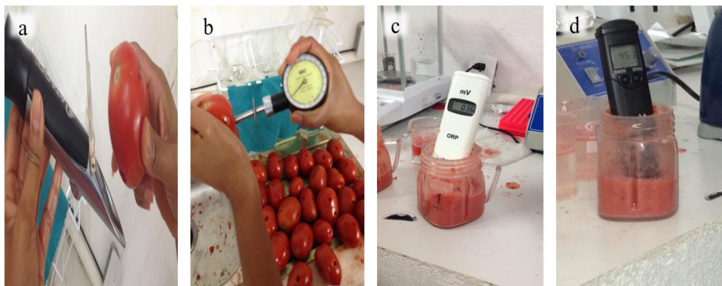
Figura 6. a) Determinación de SST, b) determinación de Fir, c) determinación de ORP, d) determinación de CE y pH.
