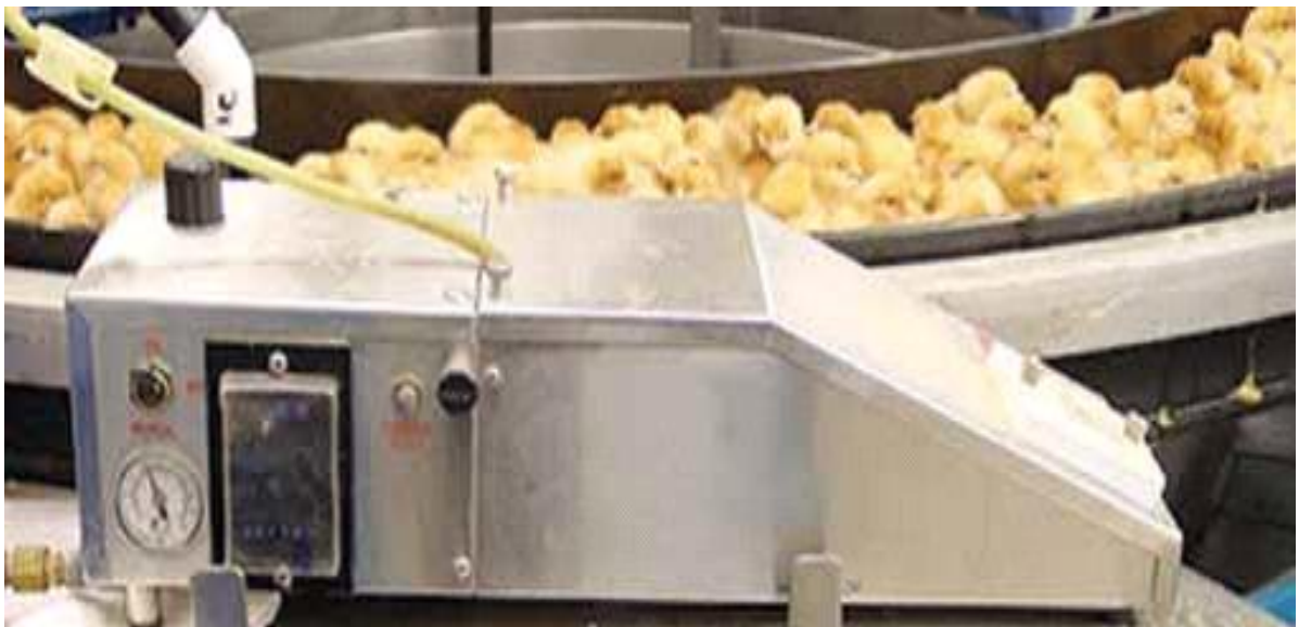
Figura 20: Máquina para vacunación subcutánea
