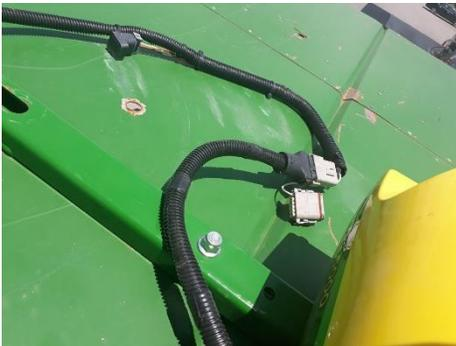
Conectar arnés de antena con el cableado del sistema del tractor.
