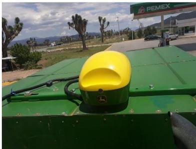
Colocación de la antena GPS en el punto medio de referencia a tomar nuestro punto cero del tractor y del implemento a utilizar. Si existe ligera variación, esta se podrá corregir mediante software. En el mismo sistema.
