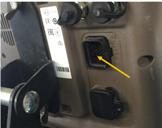
3. Quedando de este modo, cuidando cualquier alteración que pueda presentarse. Ubicar la terminal hembra en la pantalla donde va el arnés de alimentación y datos proveniente del módulo de control del piloto automático.
