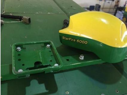
Identificación de área de montaje de antena.
