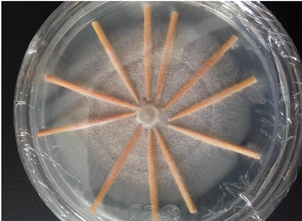
Figura 4 Palillos de madera infestados por *Fusarium* O.
