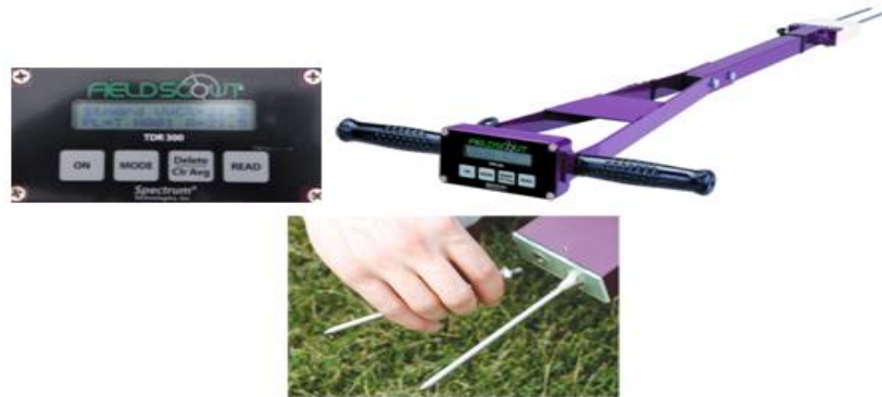
Figura 13. TDR 300 y puntas de metal
