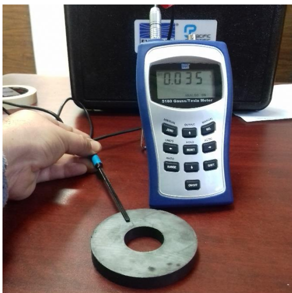
Fig. 1. Medición del campo magnético real BM del iman de anillo cerámico o de ferrita
