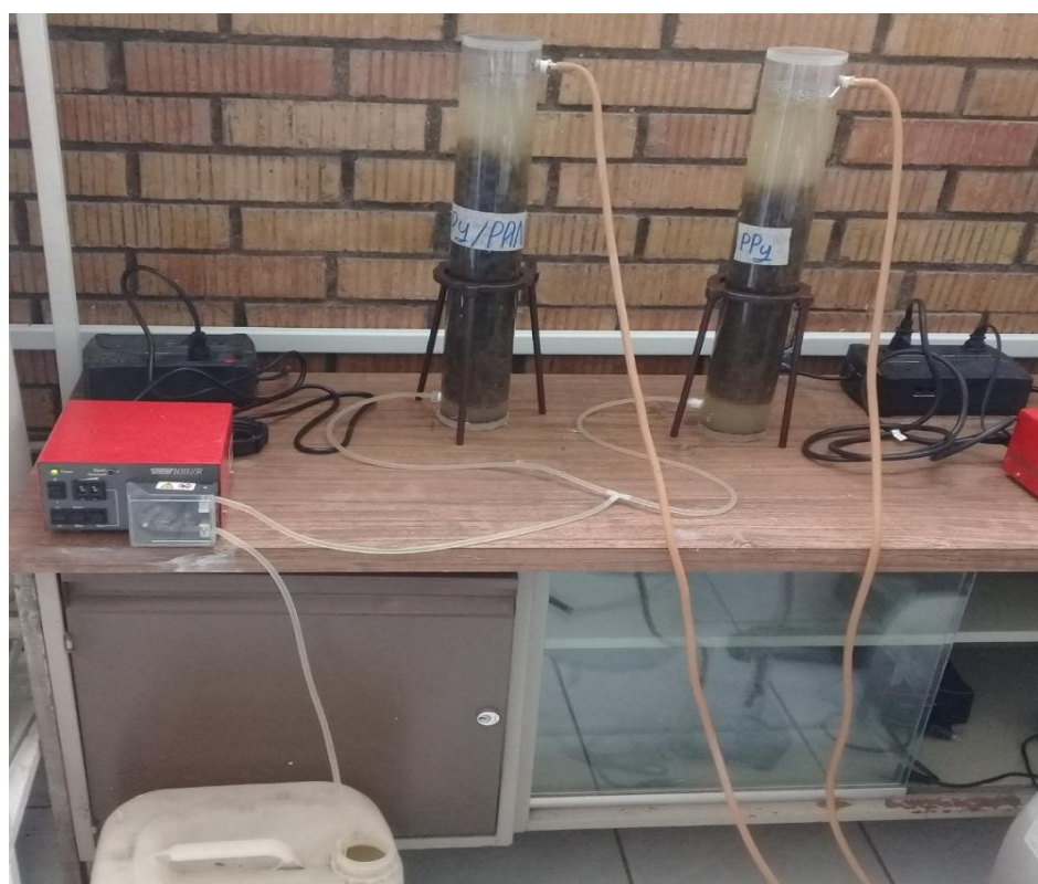
Figura 8. Arranque del filtro anaerobio
