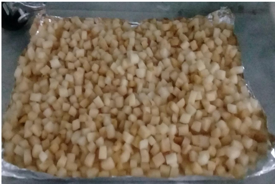
Figura 6. Espuma de poliuretano recubierta con polipirrol mediante plasma
