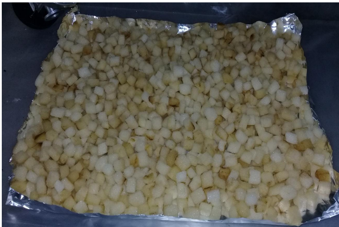
Figura 5. Espuma de poliuretano recubierta con polipirrol y polianilina mediante plasma
