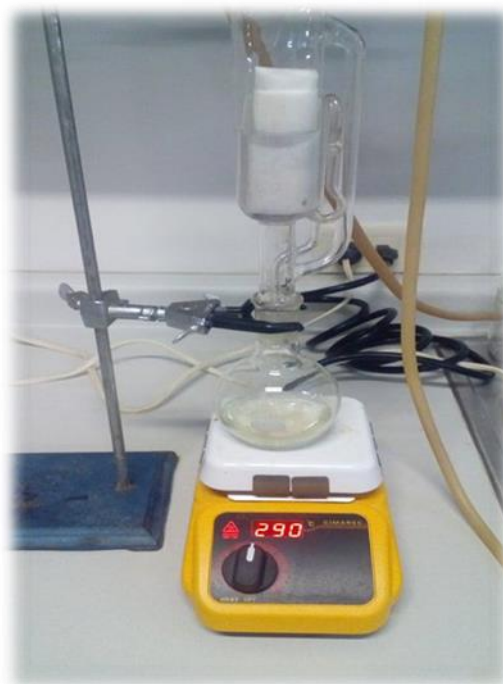
Figura 8. Extracción por Soxhlet
