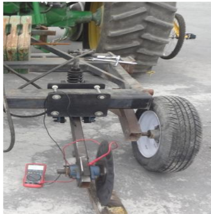
Figura 4.6 Acondicionamiento de los discos en el carro porta sensores.
