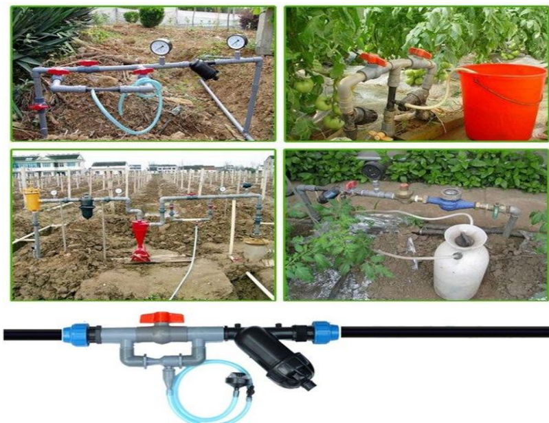
Figura 16. Inyector de fertilizantes Venturi. (Gómez, 2017).
