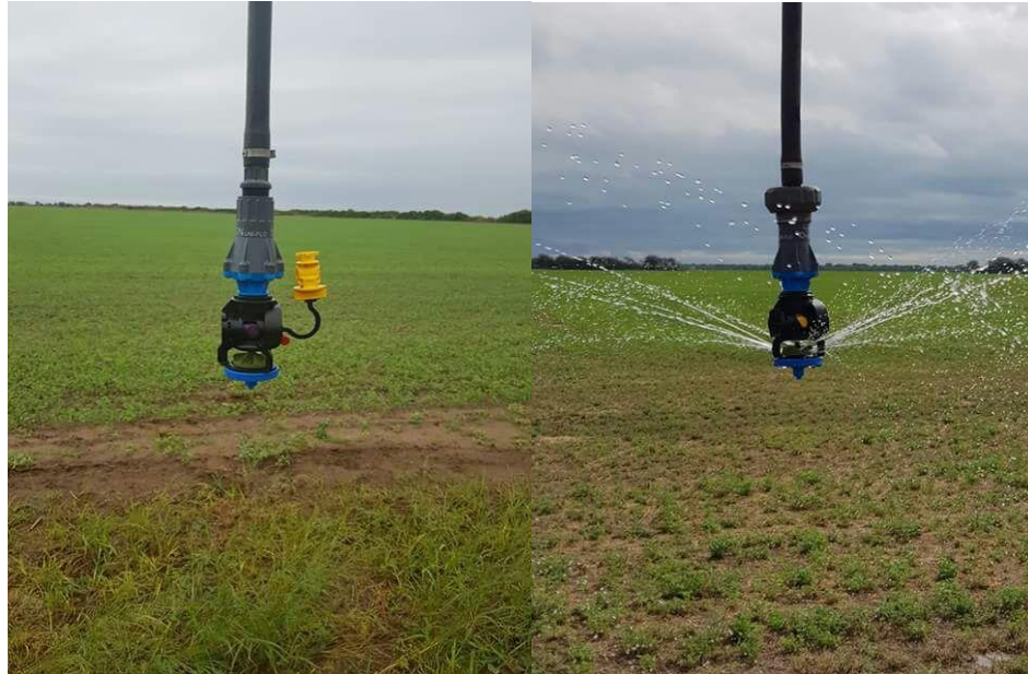
Figura 30. Difusores modernos para laterales móviles Nrlson 2003.
