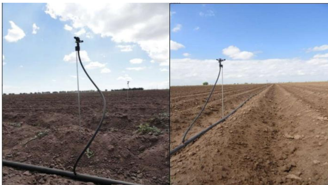
Figura 37. Sistema portátil IrriStand con aspersor de impacto modelo 5022-U
