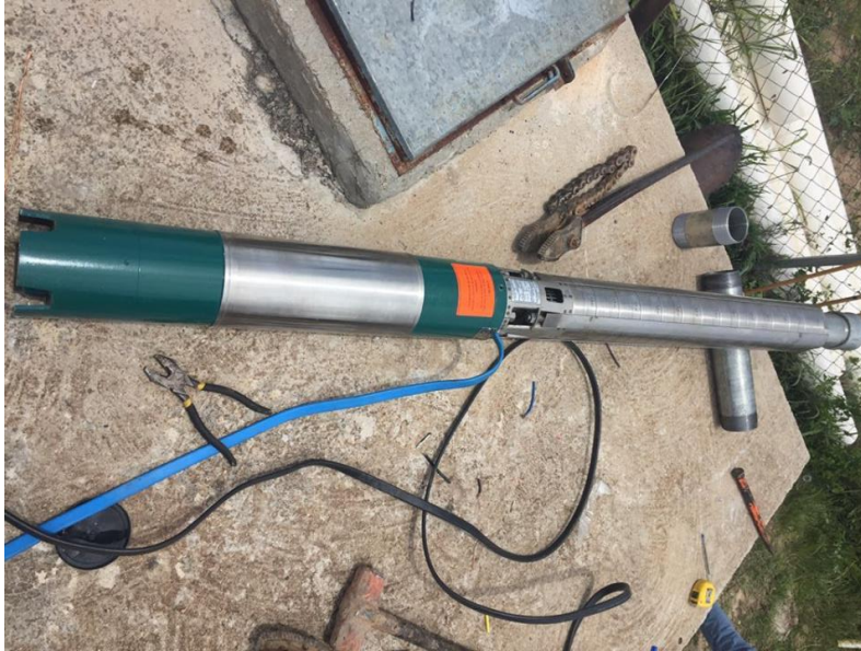
Figura 4. Bomba sumergible de 15 HP (Gómez, 2017).
