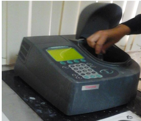
Figura 11. Medición de transmitancia con espectrofotómetro.
