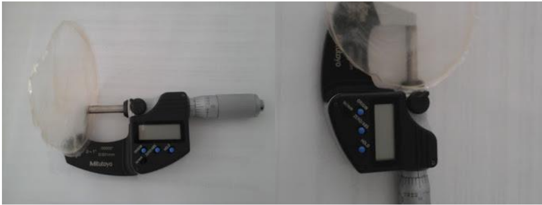
Figura 9. Determinación del grosor con un micrómetro Mitutoyo.
