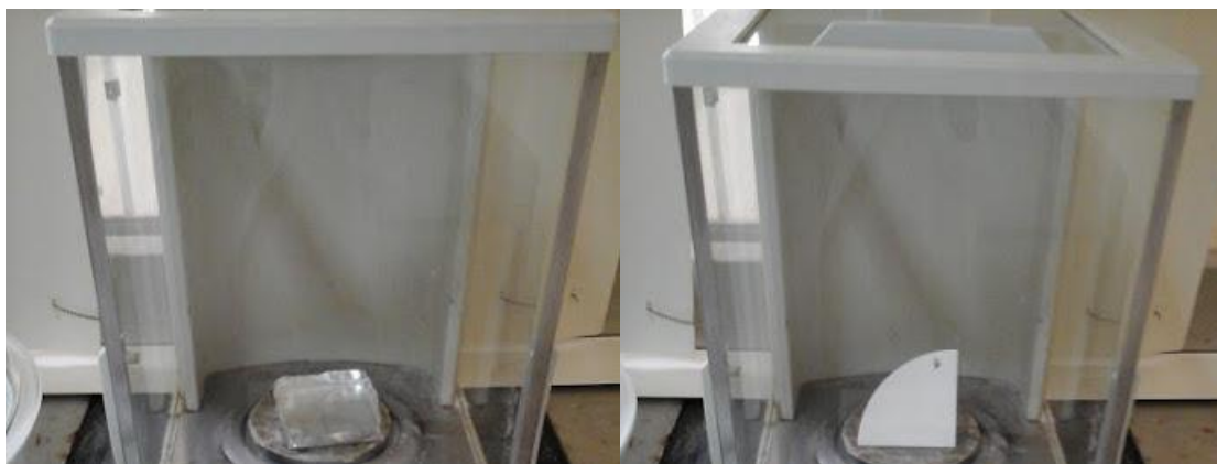
Figura 13. Peso de la película y cono en la balanza analítica (OHAUS ADVENTURER).
