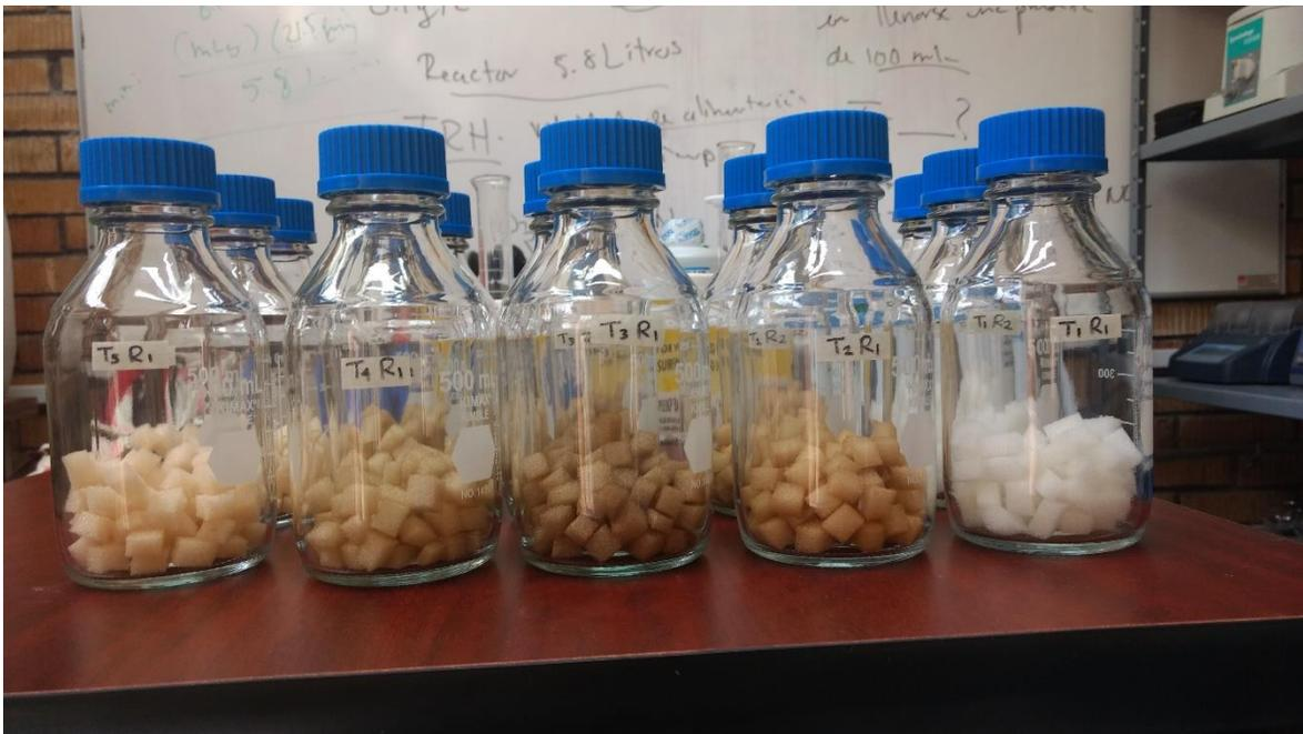
**Fig. 2.3** Soportes pre-acondicionados para el tratamiento de aguas residuales municipales
