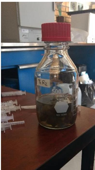
**Fig. 2.5** Reactores batch utilizados para el tratamiento de agua residual municipal.
