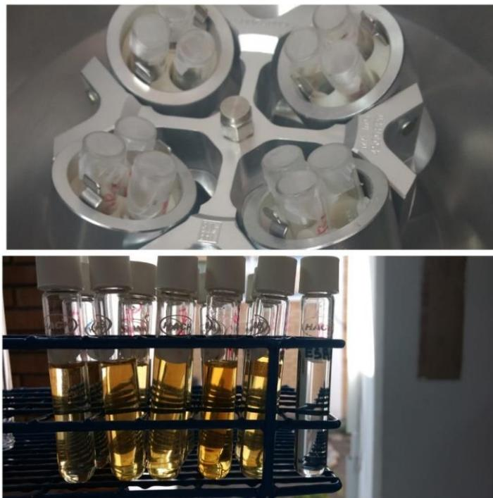
**Fig. 2.6** Centrifugado de las muestras y adición de los reactivos para la determinación de la DQO
