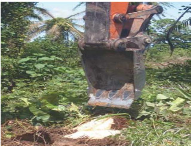
Ilustración 21. Modificaciones de la pala de la excavadora para la destrucción de estípites de palmas. (Palmeras Salamanca y Araki; foto de R. Aldana).
