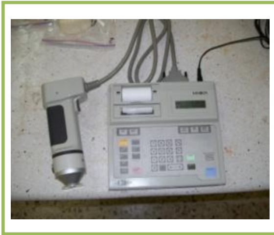
Figura 9.- Colorímetro Minolta CR -300.
