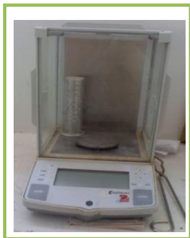
Figura 13.- Balanza analítica marca ohaus
