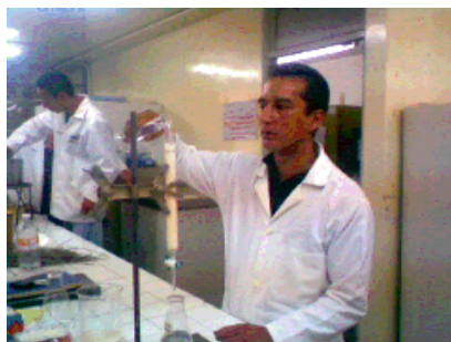
Figura 14: obtención de azúcares y polifenoles hidrosolubles en columna de amberlita
