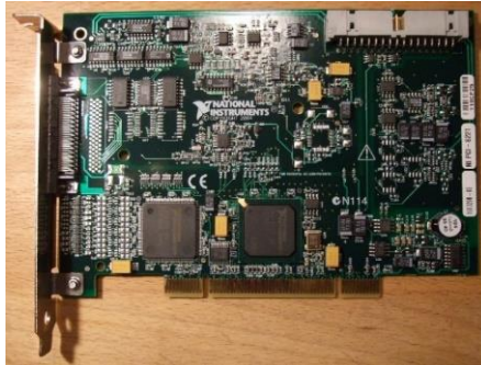
Figura 4.19 Tarjeta de adquisición de datos PCI-NI-6621.
