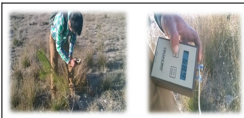
Figura 7. Medición de humedad con los sensores colocados en la plantación de Pinus greggii Engelm. establecida en Saltillo, Coahuila.
