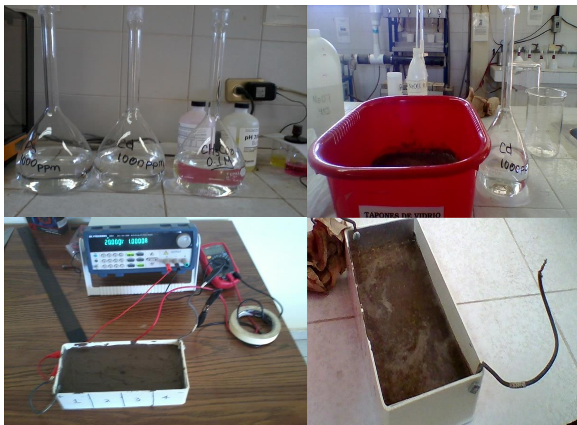
FIG 3. Solución estándar 1000ppm de Cd, Contaminación y electroremediación del suelo.
