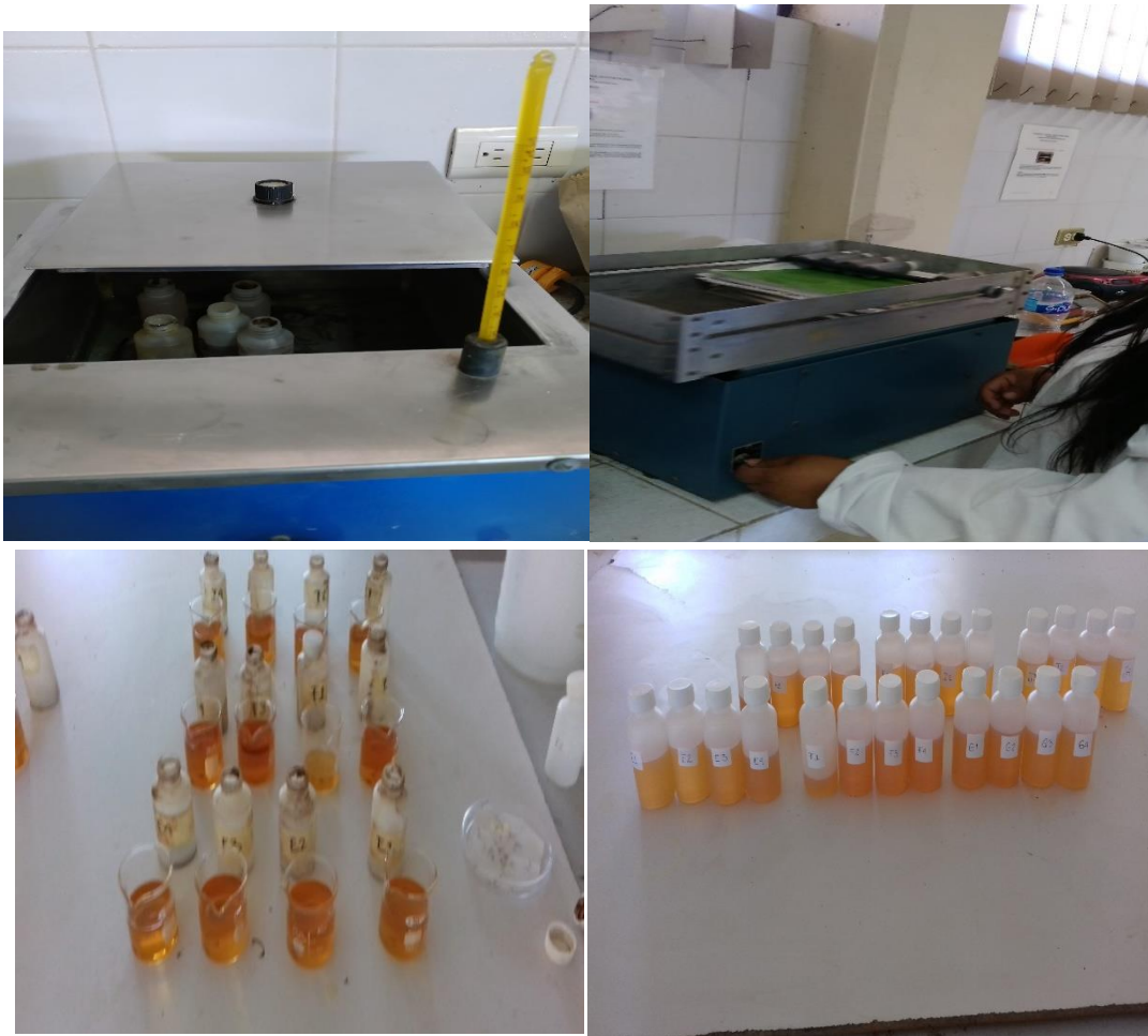
FIG 5. Procedimiento para la digestión para análisis de concentración de cadmio en suelo.
