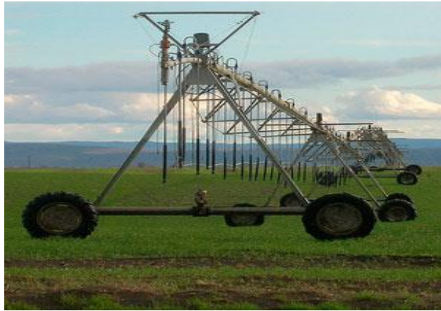
Figura 2.8 Detalles de salidas y estructura de soporte de un lateral
