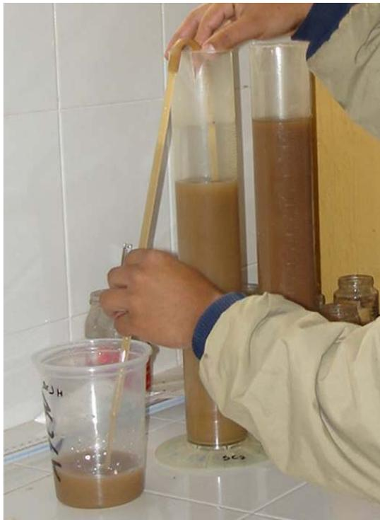
Figura 3.10 Uso de sifón para obtener las arcillas a 20 cm de profundidad
