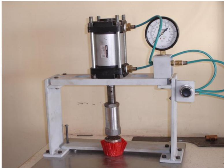
Figura 3.7 Prensa neumática simuladora de compactación
