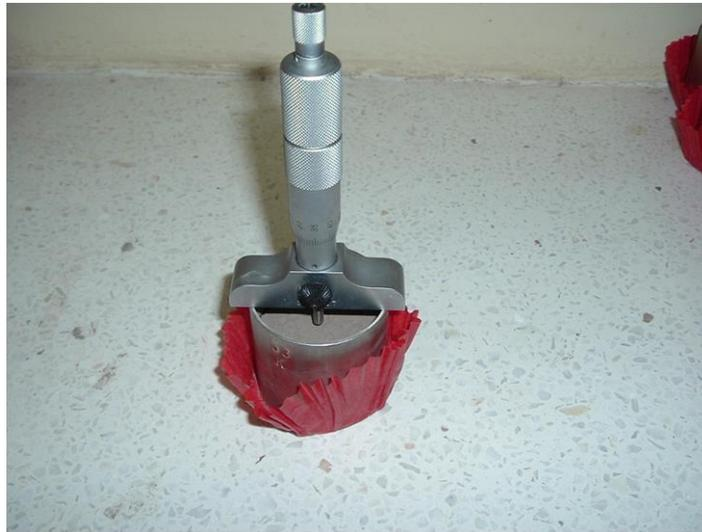
Figura 3.9 Micrómetro para medir la longitud de compactación de la muestra.
