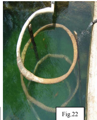
Fig. 22 Serpentin con refrigerante
