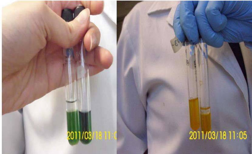
**Figura 8.** Prueba de OF. OF oxidó (izquierda): OF fermentó (derecha)
