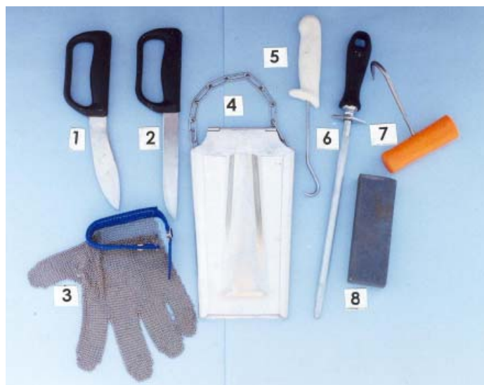
Figura 6.- Equipo de inspección. (1 y 2) Cuchillo recto y curvo de acero inoxidable y mangos de plástico. (3) Guante metálico. Muy útil cuando se inspeccionan las vísceras. (4) Porta cuchillos de acero inoxidable o material esterilizable. (5) Gancho de inspección. (6) Chaira. (7) Gancho para mover piezas cárnicas. (8) Chaira cuadrada (24).
