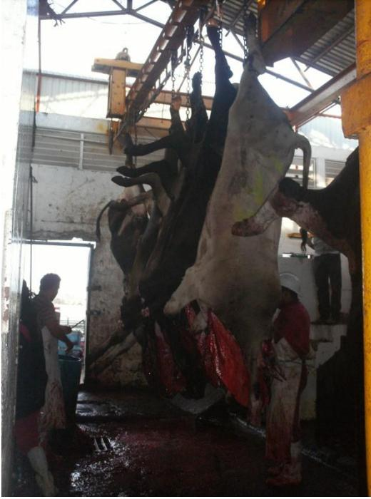
Independientemente de la capacidad de un rastro, deberá contar con rieles que estén en buenas condiciones y bien distribuidos para la facilitación de manejo que realiza el personal
