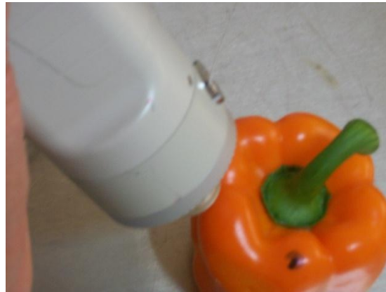
Figura 12. Determinación de color mediante un Colorímetro Konica Minolta Modelo CR-400
