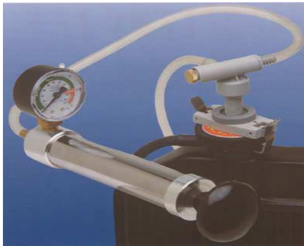
Figura 13. verificacion de la presion en la tapa del radiador.
