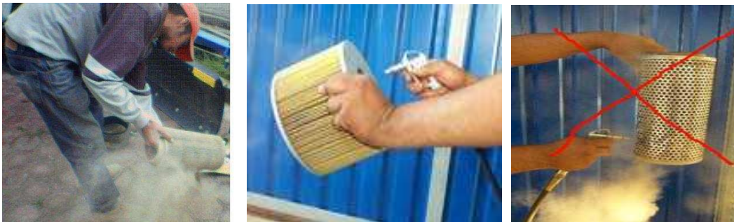
Figura 1. Limpieza del filtro tipo seco.
