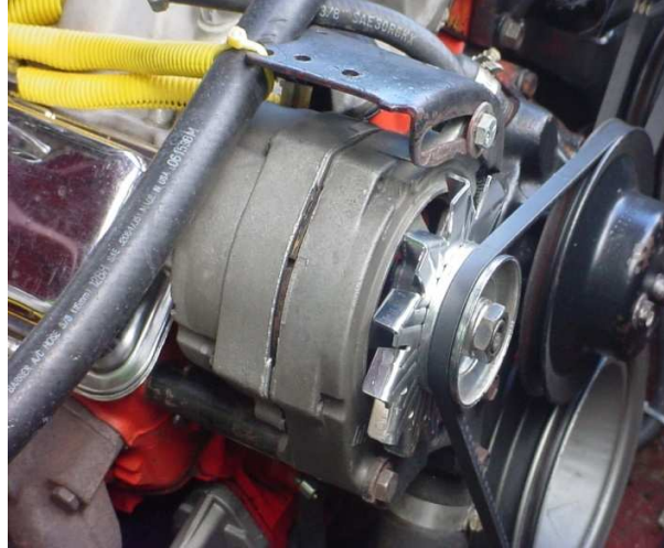
Figura 16. Alternador y correcto ajuste de la banda tipo V.
