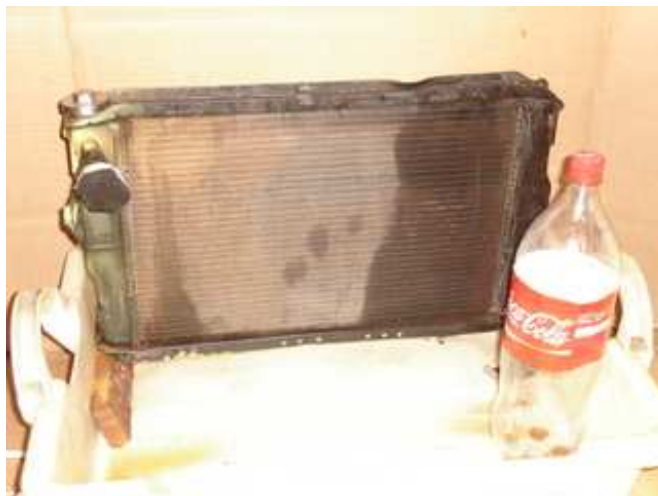
Figura 12. lavado del radiador en agua caliente por causa de la corrosión herrumbre.
